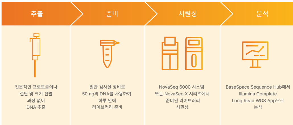
그림 1: Illumina Complete Long Read 워크플로우 — 확장 가능하고 최적화된 라이브러리 준비 프로토콜을 통해 NovaSeq 6000 시스템 또는 NovaSeq X 시리즈로 시퀀싱 후 DRAGEN 2차 분석을 수행하여 포괄적인 롱 리드 WGS 데이터 생성. Illumina Complete Long Read 라이브러리는 표준 30× WGS 라이브러리의 준비, 시퀀싱 및 분석이 반드시 동반되어야 함.
